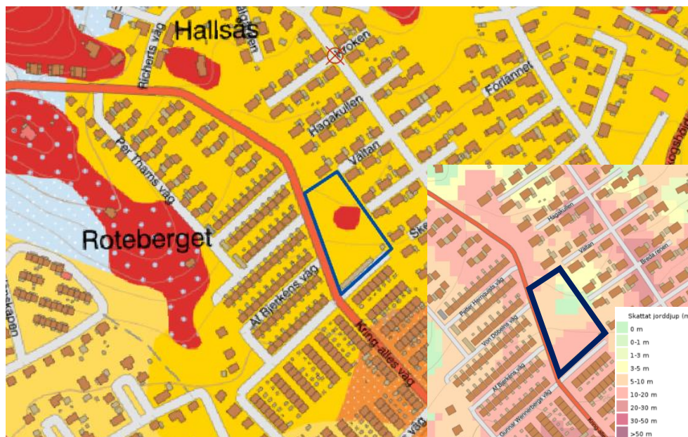
Figur 3. Jordarter inom och i anslutning till planområdet hämtat från SGUs jordartskartering. Lera visas med gult och ytligt berg med rött. Jorddjupskarta i nedre högra hörnet.
