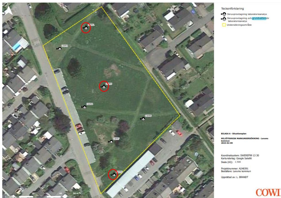
Figur 4. Provpunkter miljöteknisk markundersökning. Punkter där grundvattenrör har installerats har markerats med röd cirkel.
