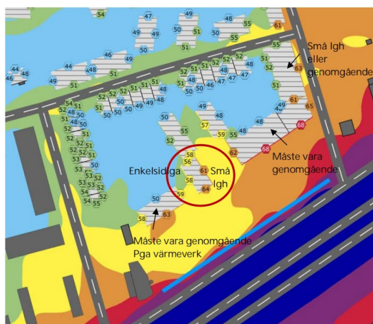
Figur 42 Påvisar bullernivåer och föreslagna åtgärder med bullerplank
